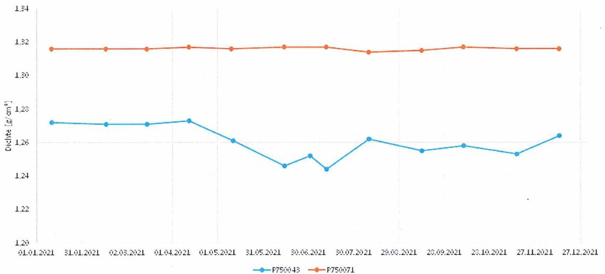
Abbildung 9.6-4: Salzlösungsdichte in den Sumpfen vor dem Blindschacht 2 und den Einlagerungskammern 4 und 8 auf der 750-m-Sohle
