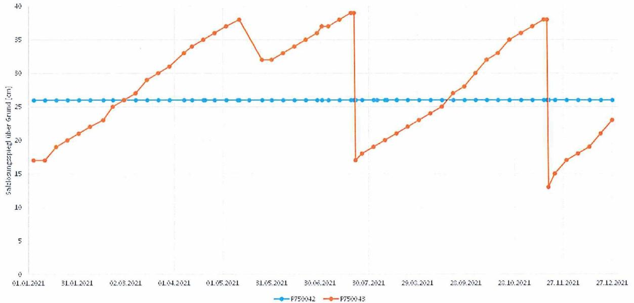
Abbildung 9.6-3: Salzlösungsspiegel in den Sumpfen vor den Einlagerungskammern 4 und 8 auf der 750-m-Sohle
